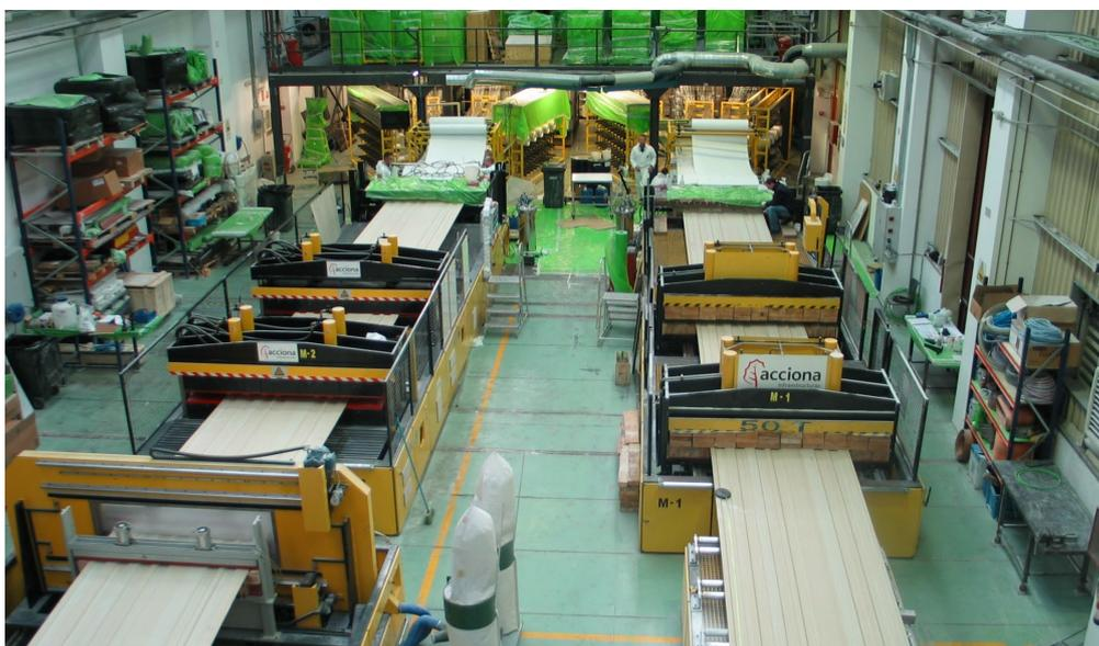
**Figura 3.** Fabricación de placas de impermeabilización mediante el proceso de pultrusión
